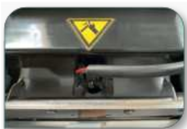
Фотоелемент для видачі стрічки. Це дозволяє оператору працювати «вільні руки» (GT-250D)
